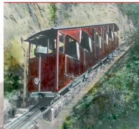
Nel **1938** le ditte Bell & Ci. di Kriens, Maschinenfabrik di Oerlikon e Kabelwerke di Brugg fornirono macchinari di trazione atti ad assicurare una maggiore sicurezza all'esercizio, ma resero necessario il cambio della fune, del pignone, delle ruote di trazione, delle pulegge del freno ed apparecchi annessi. Grazie a queste modifiche la velocità di trazione venne portata da metri 1,8 al secondo a metri 2,5 al secondo, riducendo così la durata della corsa a 14 minuti.
