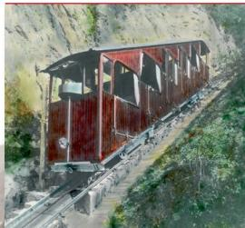
En **1938**, les entreprises Bell & Ci. de Kriens, Maschinenfabrik d'Oerlikon et Kabelwerke de Brugg fournissent des appareils de traction apportant une plus grande sécurité de fonctionnement, mais ceux-ci exigent le changement du câble, du pignon, des roues de traction, des poulières de frein et de certains appareils annexes. Grâce à ces modifications, la vitesse de traction passe de 1,8 m/s à 2,5 m/s, réduisant ainsi la durée du trajet à 14 minutes.
