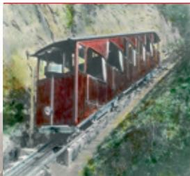
En **1938**, les entreprises Bell & Ci. de Kriens, Maschinenfabrik d'Oerlikon et Kabelwerke de Brugg fournissent des appareils de traction apportant une plus grande sécurité de fonctionnement, mais ceux-ci exigent le changement du câble, du pignon, des roues de traction, des poulies de frein et de certains appareils annexes. Grâce à ces modifications, la vitesse de traction passe de 1,8 m/s à 2,5 m/s, réduisant ainsi la durée du trajet à 14 minutes.
