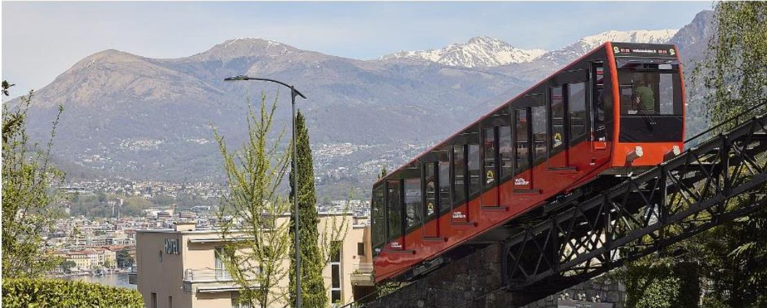
Die Strecke ist nicht elektrifiziert, die beiden Wagen sind durch ein einzelnes Zugseil aus Stahl miteinander verbunden.
