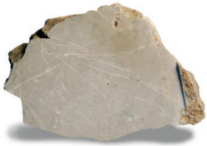
Sektion des Dolomitgesteins aus dem San Salvatore, an dem die internen Risse deutlich zu erkennen sind
